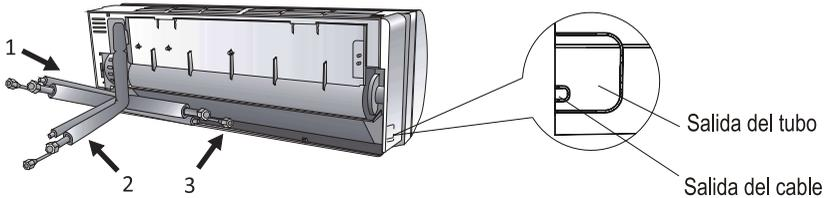
4.2 Doble los tubos de conexión con el puerto hacia arriba como se muestra en la figura.
