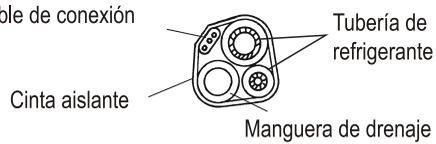
7.2 Con la cinta aislante, envuelva bien los tubos de refrigerante, los cables de conexión y la manguera de drenaje.
